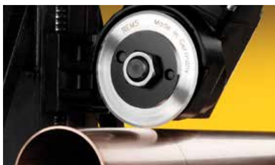
REMS skærehjul er afstemt efter de specielle krav til de forskellige materialer. Især den specielle hærtningsproces er afgørende for den lange levetid for REMS skærehjul.
